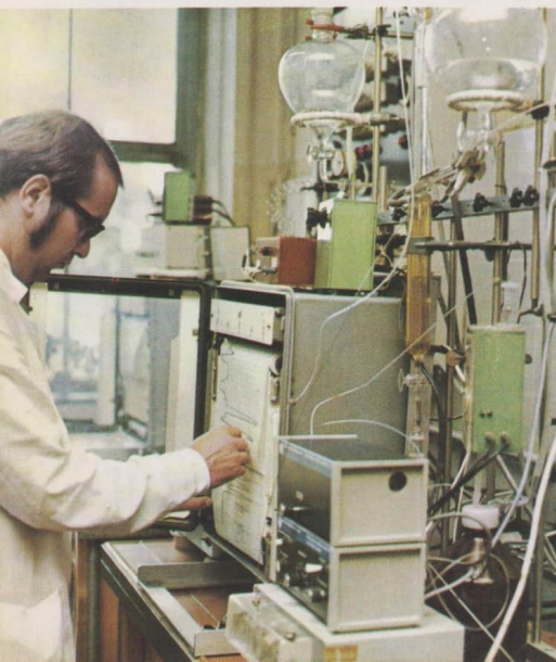
Die Gelchromatographie ist eine moderne Methode zur Bestimmung von Molekulargewichtsverteilungen in hochpolymeren Stoffen.
