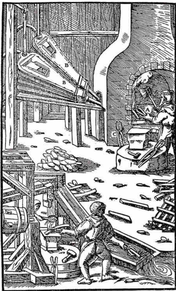
Mittelalterlicher Schmiedeofen, mittels Blasebälgen betrieben (aus G. Agricola, »De re metallica libri XII« )
