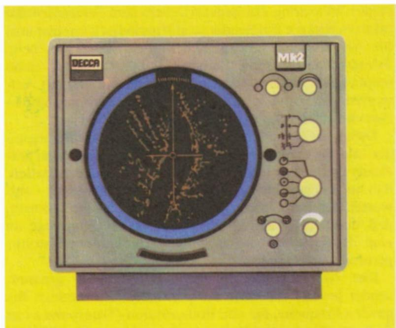
*Ufer- und Binnenlandkonturen auf dem Radarschirm (hier eines speziell für kleine Fahrzeuge entwickelten Gerätes)*
