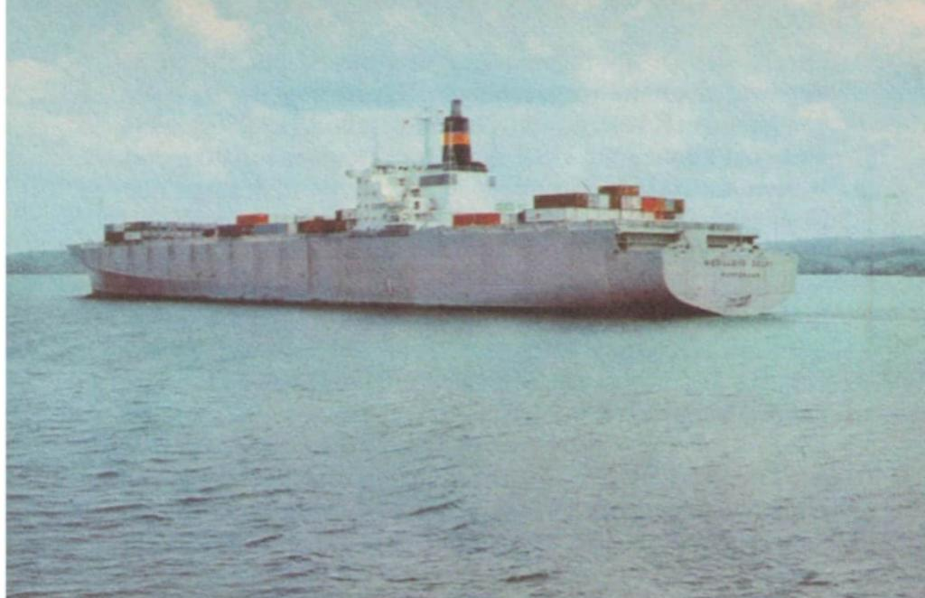
*Eines der nach den Schleusenabmessungen des Kanals »maßgeschneiderten« Panamax-Containerschiffe*
