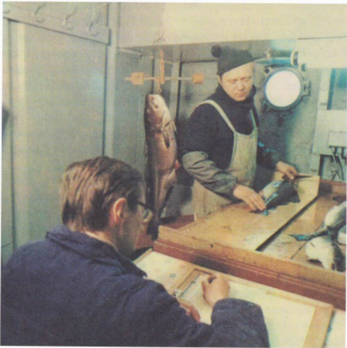
Mit Meßbrett und Balkenwaage werden Länge und Gewicht der Fischproben im Schlachtlabor an Bord gemessen.
