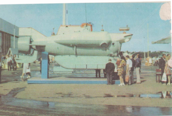
Das autonom arbeitende sowjetische Zweimann-Tauchboot »Tinro 2« wird für meeresbiologische und fangtechnische Untersuchungen eingesetzt. Länge des Bootes 7,4 m, Masse 10,5 t
