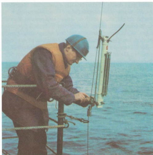
Entnahme von Seewasserproben mit dem Kipp-Wasserschöpfer
