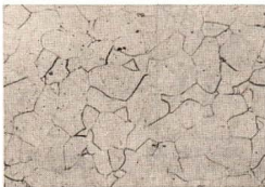
Bild 5.4. Gefüge eines technisch reinen Eisens (Vergrößerung = 200 : 1, geätzt mit alkohol. \text{HNO}_3 )
