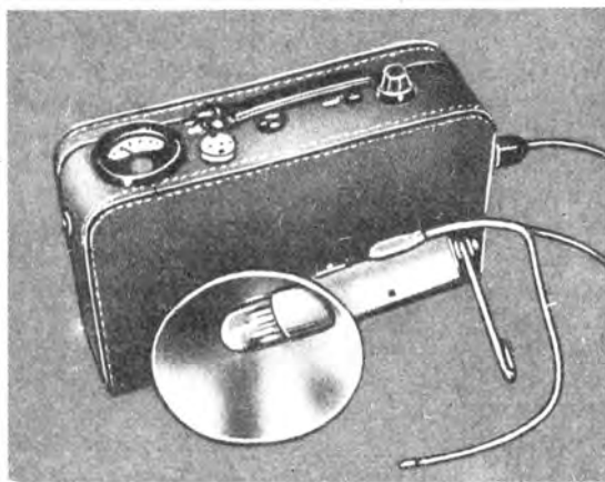
Bild 3.43 Fotoelektronenblitzgerät. Im Koffer das Gerät nach Schaltung Bild 3.41. Die Blitzlampe ist die handelsübliche »Hauptlampe« zum Blitzgerät Typ B70 (VEB Elgawa, Plauen)
