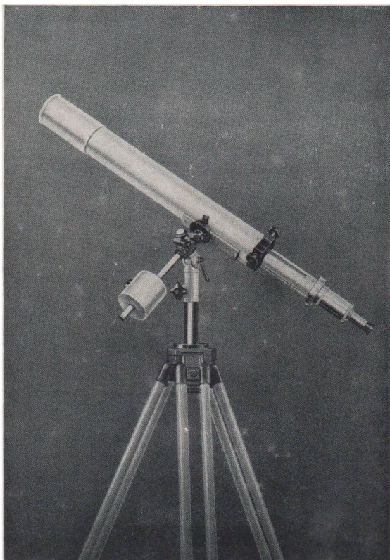
Schulfernrohr 63/840 mit einfacher parallaktischer Montierung
