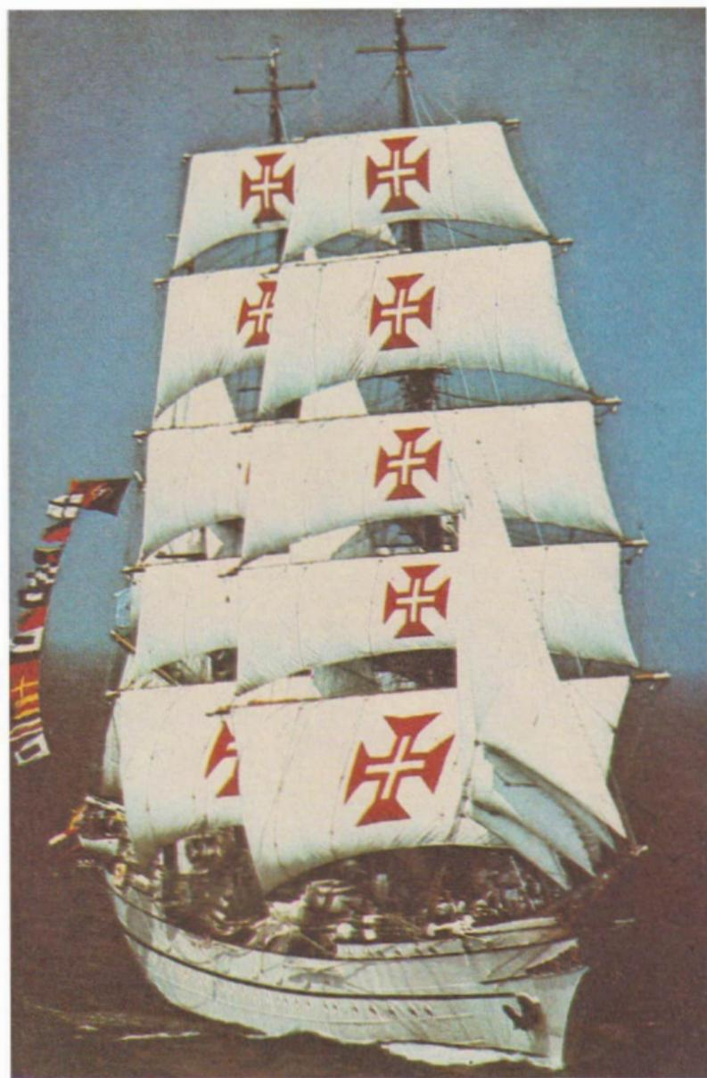
*Die »Sagres« (II) aus Alfeite bei Lissabon unternimmt jährlich zwei große Ausbildungsreisen. Länge über alles 89,48 m, Länge Rumpf 81,28 m, größte Breite 12,02 m, Tiefgang 5,3 m, 23 Segel, Hilfsantrieb Dieselmotor 552 kW (750 PS), 160 Mann Stammbesatzung, 90 Kadetten*
