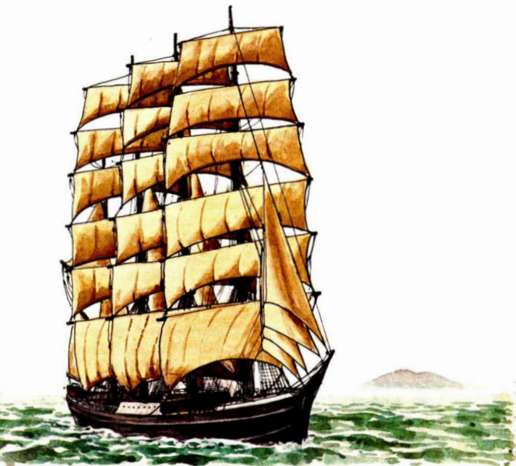
*Die Viermastbark »Pamir«. Länge zwischen den Loten 94,49 m, größte Breite 14,02 m, Seitenhöhe bis Oberdeck 8,48 m, Tiefgang max. 7,07 m, Vermessung 3 103 BRT, Displacement 6 420 ts, Kapazität der Ballastwassertanks 768 t, der Treiböltanks 116 t, Segelfläche 4 100 m<sup>2</sup>, Hilfsantrieb Dieselmotor von 900 PS = 6,5 kn, Höchstgeschwindigkeit unter Segeln 16 kn*
