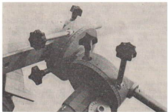
Schulmontierung mit Teilkreisen, Klemmungen und Feinbewegungen
