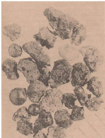
Abbildung 1 Bruchstücke von Mondgestein, die von Apollo 11 mitgebracht und im Smithsonian-Observatorium untersucht wurden. Die Muster sind so ausgewählt, daß sie die Mehrzahl der Typen des Gesteinsmaterials repräsentieren. Deshalb sind die Proportionen ihres Auftretens in der Gesamtprobe nicht beibehalten. In 1676 Proben von 1–5 mm Durchmesser befanden sich 52,4 % Bodenbrekzien, 37,4 % Basalte, 5,1 % Glas, 3,0 % Feldspatgesteine, 1,5 % sonstiges Gestein (einschließlich Meteoritenteilchen). Als Bodenbrekzien werden provisorisch die lockeren feinkörnigen Oberflächenbrekzien bezeichnet. Es handelt sich wahrscheinlich um ein durch Glas zusammengehaltenes Gemisch aus feinen Mineralteilchen und hat eine basaltähnliche Zusammensetzung. Die Konsolidierung in Klumpen ist offensichtlich durch Stoßeinwirkung erfolgt.
