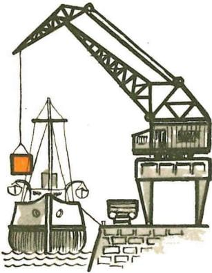
Säcke mit Getreide, Mehl, Zucker, Salz oder Düngemitteln werden mit einer **Seilschlinge** am Haken befestigt, meist mehrere auf einmal.
