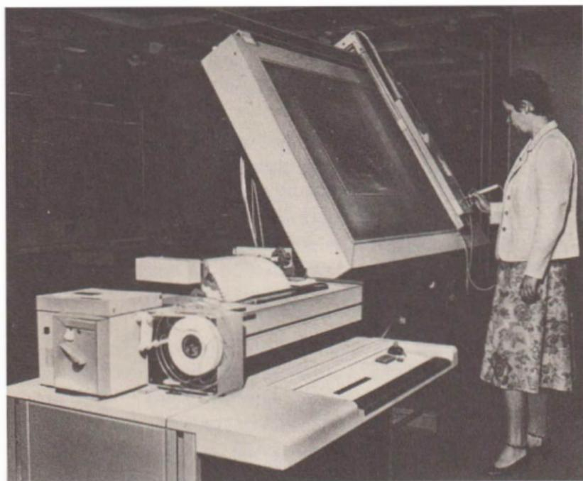
Mikroelektronik »in eigener Sache«: Mikrorechnergesteuerter Leiterkartenentwurfplatz
