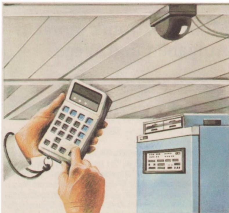
**Terminal mit Infrarotübertragung – Hilfe bei der mobilen Datenübertragung in Betrieben**
