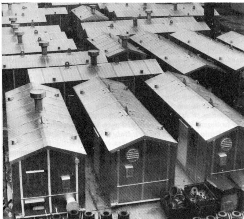
Beheizbare Metalleichtbauhäuschen, hergestellt in Fürstenwalde für den Einsatz im sowjetischen Tjumen-Gebiet (Westsibirien) zur Erschließung von Erdölvorkommen
