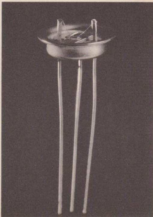
Montierter Transistor (vergrößert)
