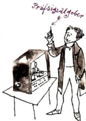
„Multivibrator“. Dieser macht seinem Namen „Vielschwinger“ alle Ehre: Er erzeugt ein Gemisch von Wechselspannungen der verschiedensten Frequenzen, von niedrigen Tonfrequenzen bis zu Hochfrequenzen, wie sie von Funksendern ausgestrahlt werden.
