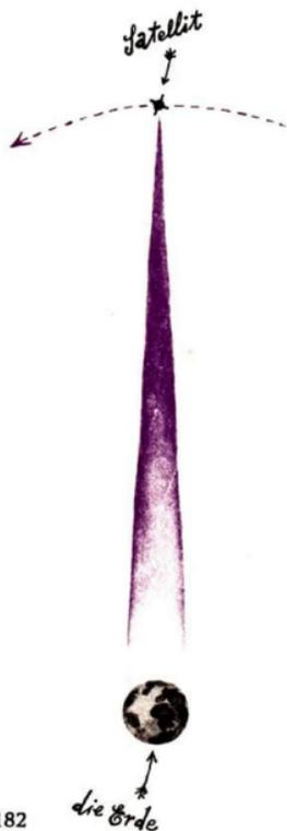
sender emporgeschickt werden. Ein Frequenzumsetzer überträgt das empfangene Programm in den Frequenzbereich des Ferns Rundfunks. Vom Sender des Satelliten wird es zur Erde zurückgestrahlt.
