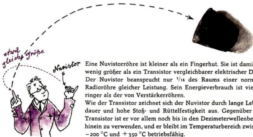
Eine Nuvistorröhre ist kleiner als ein Fingerhut. Sie ist damit nur wenig größer als ein Transistor vergleichbarer elektrischer Daten. Der Nuvistor beansprucht nur  $\frac{1}{15}$  des Raums einer normalen Radioröhre gleicher Leistung. Sein Energieverbrauch ist viel geringer als der von Verstärkerröhren.
