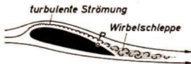
Bild 33 Schlitzflügel
