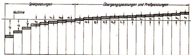
106.2 Toleranzfelder für Innerteile (Wellen)
