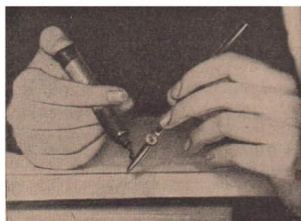
8.4 Füllen der Ziehfeder aus der Tuschepatrone
