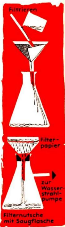
dungen von Vakuumgeräten sind mit gut sitzenden Gummistopfen, die am besten noch mit Duosan abgedichtet werden, auszuführen. Noch geeigneter sind natürlich gefettete Schiffe.
