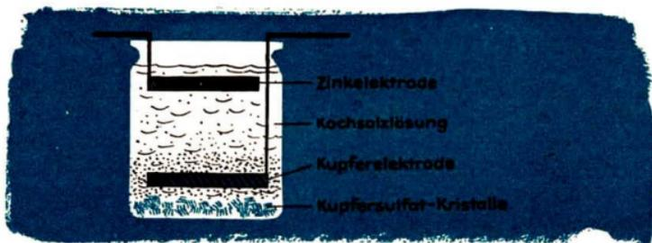
glases angebracht. Die gesamte Zelle wird mit gesättigter Kochsalzlösung gefüllt. Auf den Boden des Glases schütten wir eine Handvoll Kupfersulfatkristalle. Die schwerere Kupfersulfatlösung vermisch sich bei ruhigem Stehen nur sehr langsam mit der überstehenden Kochsalzlösung. Beim Betrieb scheidet sich daher Kupfer ab, während im oberen Teil der Zelle Zink als Chlorid bzw. Sulfat gelöst wird.
