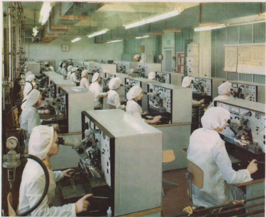
*«Operationssaal-Atmosphäre»: Endfertigung von Halbleiterbauelementen im VEB Funkwerk Erfurt*
