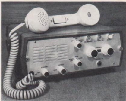
*UKW-Sprechfunkgerät für Nahverbindungen im Seefunkverkehr; seine Bedienung ist so einfach wie die eines Fernsprechers*
