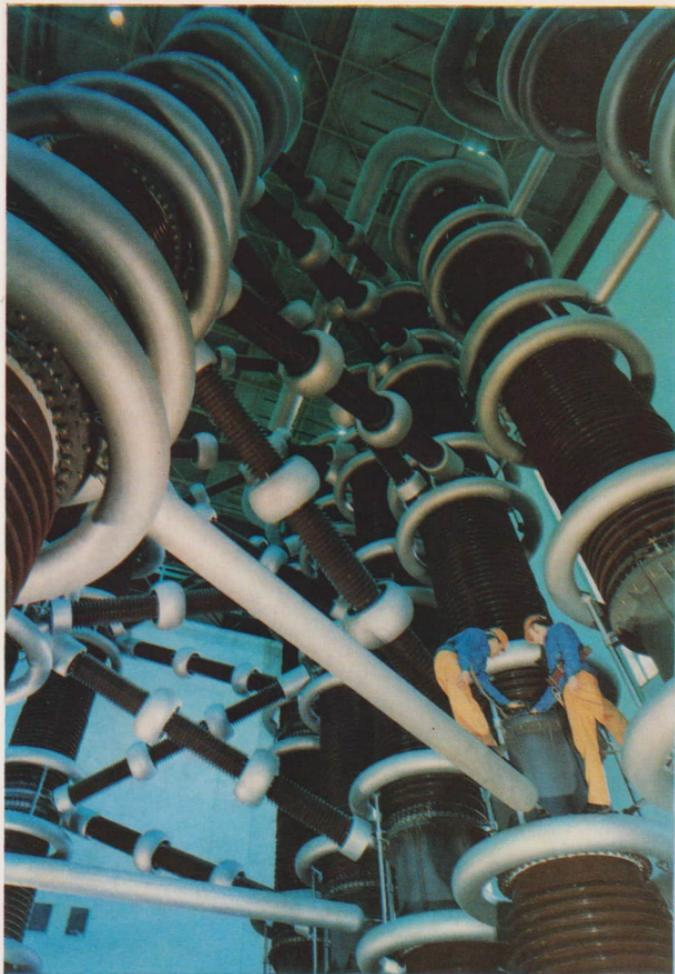
*Die erste Pulsationsspannungs-Prüfanlage der Welt mit einer Spannung von 1600 kV während der Montage*
