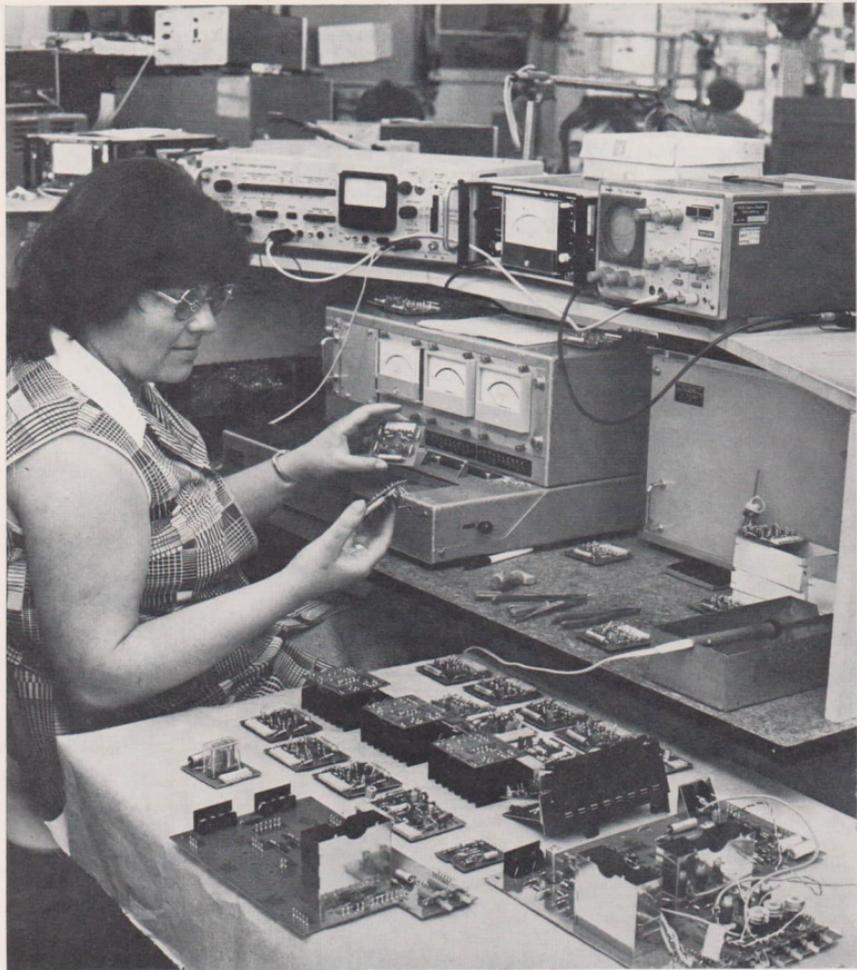
*Moderne Empfangsgeräte sind aus leicht auswechselbaren «Modulen» zusammengesetzt; sie werden auf «Herz und Nieren» geprüft*
