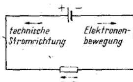
Minuspol eine Elektronenanhäufung und am Pluspol ein Elektronenmangel vorhanden ist. Über den geschlossenen Stromkreis erfolgt der Ausgleich so lange, bis kein Potentialunterschied mehr vorhanden, die Spannungsquelle demnach entladen ist. Bild 4 zeigt diese beiden Vorgänge.
