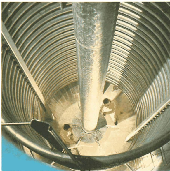
Blick in einen geleerten Bioreaktor zur Großproduktion von Penicillin. Deutlich erkennbar sind Rührwerk und Kühlmantel.
