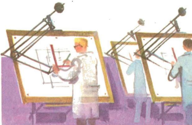
Überall arbeiten heute Maschinen. Auch die Zeichner haben eine Zeichenmaschine. Sie enthält: Lineal und Winkelmaß, Reißschiene und Winkel.
