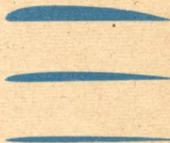
Querschnitte durch Tragflügel für Flugzeuge mit 800 km/h, 1000 km/h, 2000 km/h (von oben nach unten)
