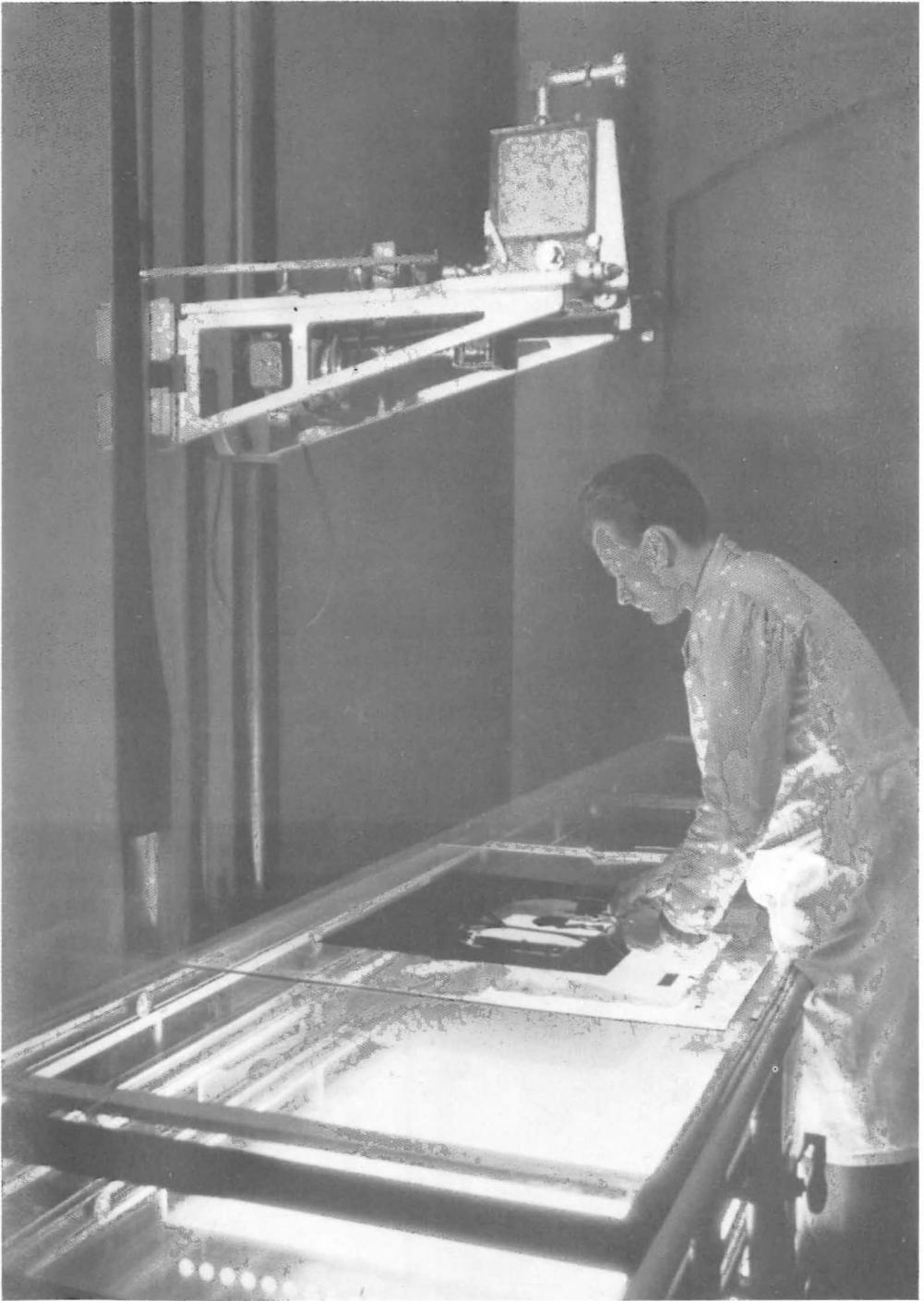
An einem solchen Tisch werden die vielen gezeichneten Bilder eines Zeichentrickfilms von der Kamera (oben im Bild) aufgenommen.
