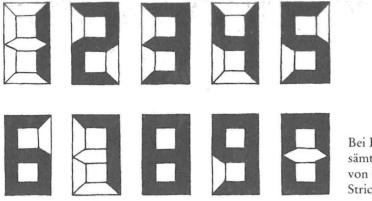
Bei Digitaluhren werden sämtliche Ziffern von 0 bis 9 mit sieben Strichen dargestellt
