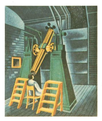
Spezialfernrohr der Sternwarte Pulkowo bei Leningrad zur Beobachtung des Meridian-Durchgangs von Sternen. Mit ihm kann die Rotationszeit der Erde sehr genau gemessen werden
