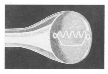
Leuchtspur auf dem Bildschirm eines Oszillographen. Sie dient zur Anzeige sehr kurzer Zeiten
