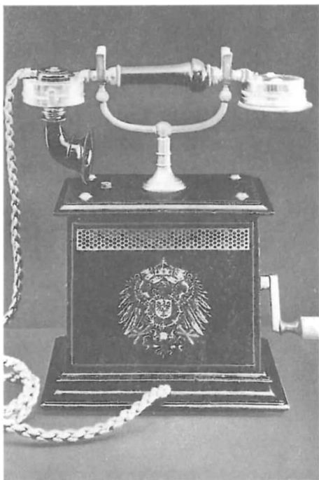
Alte Fernsprechapparate. In den beiden oberen Bildern ist der Hakenumschalter deutlich zu erkennen
