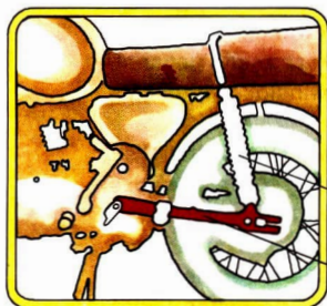
Hinterradfederung Das Hinterrad eines Motorrades wird in einer Schwinge (1) geführt und von einer Feder (2) abgestützt
