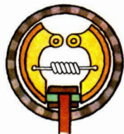
Trommelbremse gelöst: Eine Feder hält die Bremsbacken von der Bremstrommel fern
