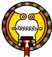
Trommelbremse in Funktion: Beide Bremsbacken werden an die Brems- trommel gepreßt.
