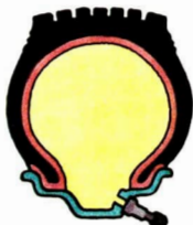
Querschnitt durch einen schlauchlosen Reifen
