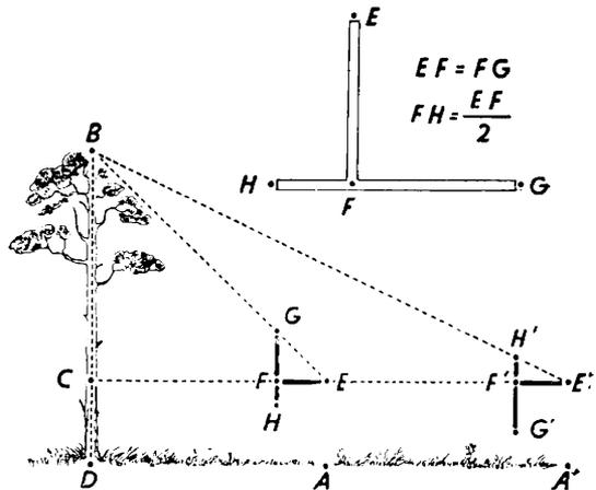
Abb. 10. Gebrauch des einfachen Höhenmessers aus zwei Leisten.
