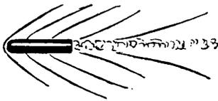
Abb. 49. Die durch ein fliegendes Geschoss erzeugten Luftwellen.
