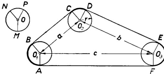
Abb. 132. Schematische Darstellung eines Antriebs. Wie wird die Länge eines Treibriemens bestimmt, wenn nur die hier angegebenen Maße benutzt werden?
