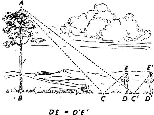
Abb. 16. Das Spiegelverfahren wird zweimal angewendet.
