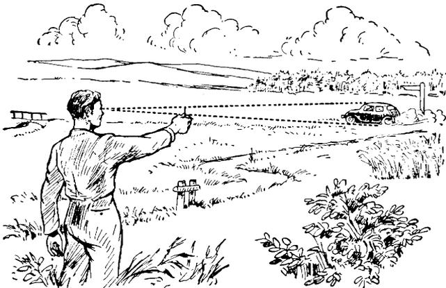
Abb. 38. Mit dem Streichholz werden unzugängliche Entfernungen bestimmt.
