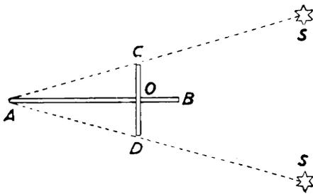
Abb. 68. Bestimmung des Winkels zwischen den Sternen mit dem Jacobstab.
