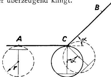
Abb. 121. Die zusätzliche Drehung bzw. das Abwölzen eines Kreises über eine geknickte Strecke wird offenbar.
