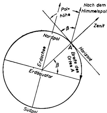
Abb. 104. Mit Hilfe des Polarsterns wird die geographische Breite des Ortes bestimmt.
