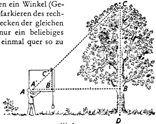
Abb. 5. Die Höhe eines Baumes wird mit dem Stechnadelgerät gemessen.
