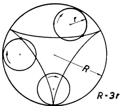
Abb. 124. Eine Dreikanthypozykloide wird von einem Punkt auf einer Kreisscheibe beschrieben, die auf dem inneren Umfang eines größeren Kreises abrollt.  $R = 3r$ .
