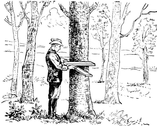
Abb. 19. Der Förster bestimmt den Baumdurchmesser.
