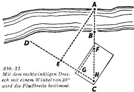
Abb. 31. Mit dem rechtwinkligen Dreieck mit einem Winkel von  $30^\circ$  wird die Flußbreite bestimmt.
