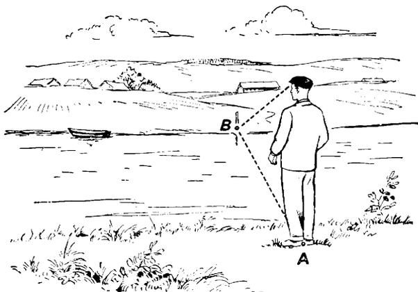
Abb. 32. Mit dem Rand des Mützenschirmes wird ein Punkt am anderen Ufer anvisiert.
