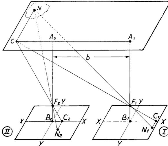
Abb. 75. Schematische Darstellung des Wolkenpunktes auf den Fotoplaten von zwei auf den Zenit gerichteten Fotoapparaten.
