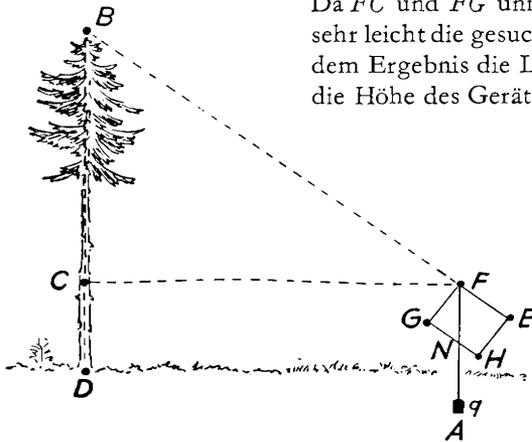
Abb. 11. Zeichnung für den Gebrauch des Höhenmessers des Försters.
