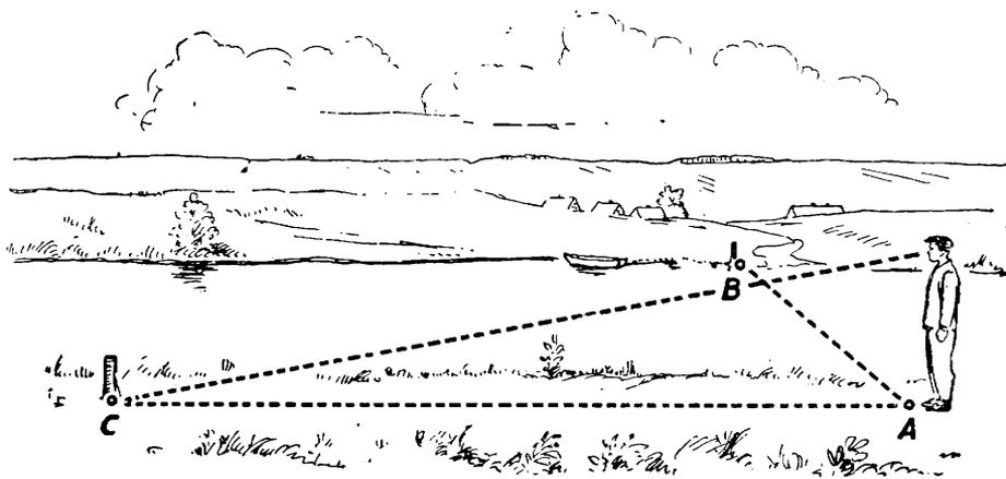
Abb. 33. In der gleichen Weise visiert man mit dem Mützenschirm einen Punkt diesseits des Stromes.
