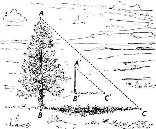
Abb. 1. Messen der Baumhöhe mit Hilfe der Schatten.
