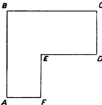
Abb. 136. Der Schwerpunkt der Platte soll mit dem Lineal gefunden werden.
