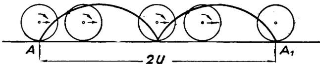
Abb. 123. Die Zykloidenkurve ist die Bahn des Punktes A auf der Peripherie eines Kreises, der ohne Reibung in gerader Richtung vorwärts rollt.
