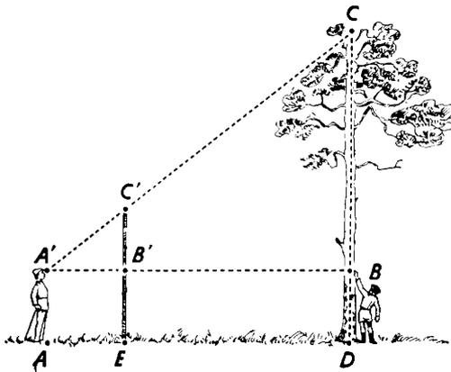
Abb. 8. Messen der Baumhöhe mit dem Pfahl.
