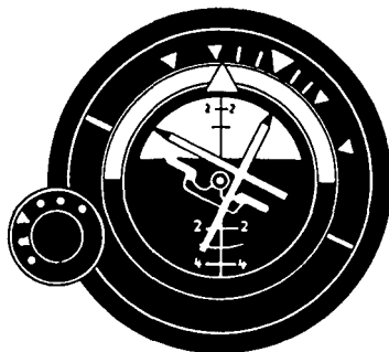
Horizon Flight Director HZ-1. Das Gerät weist Roll-Lage-Vertikal-Meridian, Flight-Director-Kreuz und Balkenanzeige für die Anstellung der Rumpfachse
