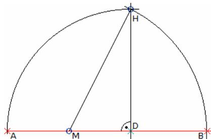
**Goldener Schnitt, Konstruktion**
