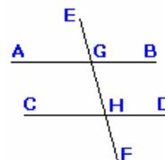
Man bringe nämlich die gerade Linie EF mit den parallelen Geraden AB, CD zum Schnitt. Ich behaupte, dass dann die Wechselwinkel AGH, GHD gleich werden, der äußere Winkel EGB dem innen gegenüberliegenden GHD gleich und die innen auf derselben Seite entstehenden Winkel BGH + GHD = 2 R.
