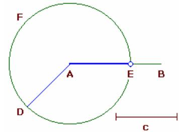
Die zwei gegebenen ungleichen Strecken seien AB, c; von ihnen sei AB die größere. Man soll auf AB, der größeren Strecke, eine c, der kleineren, gleiche abtragen.
