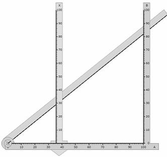
Die Teile des Gerätes bilden ein rechtwinkliges Dreieck. Eine Kathete A ist mit der Hypotenuse H an einem Drehpunkt fixiert. Die zweite Kathete B ist mit A im rechten Winkel verschraubt. Parallel zu B ist eine in zwei Richtungen verschiebbare und skalierte Flachstange X angebracht.
