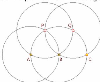
Aufgabe: An eine gegebene Strecke  $AB$  soll eine weitere Strecke  $BC = AB$  angefügt werden, d.h. die Strecke  $AB$  soll verdoppelt werden.
