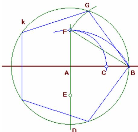
Aufgabe: Eine Strecke ist durch einen Punkt so zu teilen, dass der größere Abschnitt AC die mittlere Proportionale aus dem kleineren Abschnitt BC und der ganzen Strecke AB wird, d.h.
