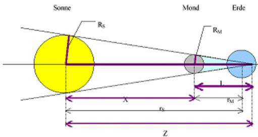
Herleitung:  $R_S / R_M = Z / L$   $R_S / R_M = (X + L) / L$
