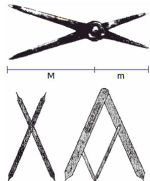
Nach dem Strahlensatz stellt sich auf der einen Seite ein Major und auf der anderen Seite der zugehörige Minor ein. Dieser goldene Zirkel ist so konstruiert, dass die Punkte P bzw. Q die gleichlangen Schenkel AS und SB im goldenen Schnitt teilen, und außerdem  $PT = PA$ , sowie  $QT = QB$  gilt.
