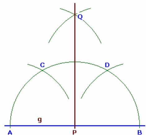
Man zieht mit dem rostigen Zirkel einen Halbkreis um P und erhält dadurch die Punkte A und B. Nun schlägt man um A und B je einen Kreisbogen und schneidet sie mit dem Halbkreis um P, die Schnittpunkte seien C und D. Man schlägt nun von C und D je einen Kreisbogen; der Schnittpunkt Q der beiden Kreisbögen bildet mit Punkt P die Winkelhalbierende.
