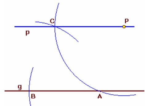
Grundlage dieser Konstruktion ist die Tatsache, dass das Viereck PABC Rhombus ist, dessen gegenüberliegende Seiten parallel zueinander sind. In Euklids "Elementen" wird diese Konstruktion unter § 31 (A. 10) ausgeführt.
