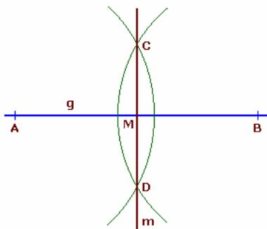
2. Zeichne um diese beiden Punkte jeweils einen Kreis mit einem Radius größer als r. Verbinde die beiden Schnittpunkte C und D dieser Kreise und verlängere sie in beide Richtungen.
