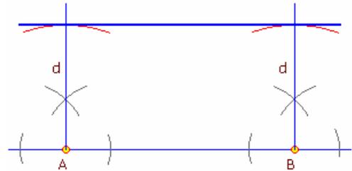
Grundlage dieser Konstruktion ist die Tatsache, dass das entstehende Viereck ein Rechteck mit einer Seitenlänge  $d$  ist.
