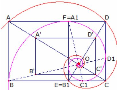
Wie auf der vorhergehenden Lexikonseite gezeigt wurde, liegen die Punkte B, A1, D1, C1, ... auf einer logarithmischen Spirale mit der Polargleichung  $r = p^{2 \cdot \theta/\pi}$
