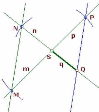
Aufgabe: Gegeben sind drei Strecken  $m, n$  und  $p$ . Zu konstruieren ist die 4. Proportionale, d.h. eine Strecke der Länge  $q$  mit  $m/n = p/q$ .
