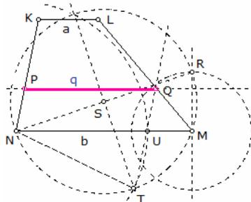
1) Konstruktion einer Senkrechten zu  $MN$  im Punkt  $M$  und eines Kreises um  $M$  mit dem Radius  $a$ . Der Schnittpunkt ist  $R$ . Die Strecke  $RN$  ist dann nach dem Satz des Pythagoras  $RN = \sqrt{(a^2 + b^2)}$ .
