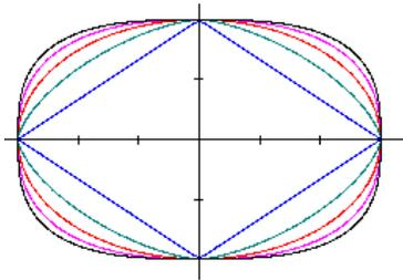
Es ist möglich, einen Rhombus in einem Koordinatensystem nur durch eine Gleichung zu beschreiben. Die Zahlen im Nenner der Gleichung findet man in der Zeichnung als halbe Diagonalen. Damit ist der Rhombus der Grenzfall  $n=1$  einer Lamé-Kurve  $|x/a|^n + |y/b|^n = 1$ .
