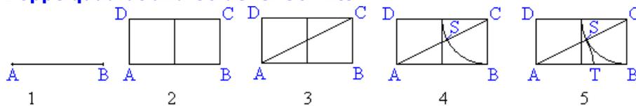
Will man den Teilpunkt T des goldenen Schnitts durch Konstruktion finden, benutzt man ein Doppelquadrat  $a \times 2a$  und nutzt aus, dass  $\sqrt{5} a$  die Länge der Diagonalen
