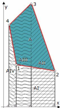
Die doppelte Fläche entspricht der Summe des aktuellen Rechtswertes und des darauf folgenden, multipliziert mit der Differenz aus aktuellem Hochwert und folgendem Hochwert.
