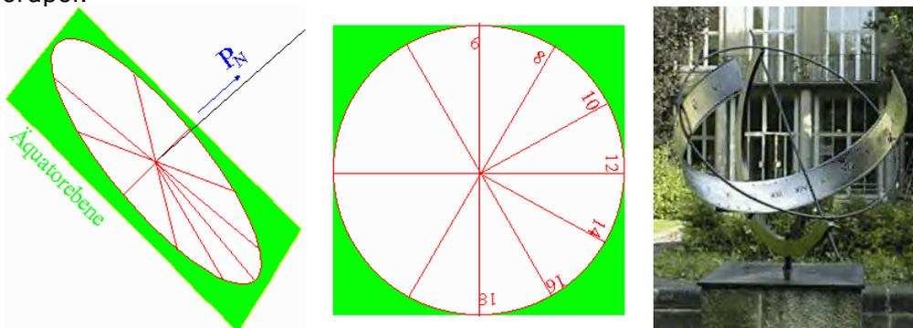
Damit der Schatten auf dem Zifferblatt auch bei negativen Deklinationen der Sonne sichtbar ist, müsste ein ebenes Zifferblatt transparent sein. Das Zifferblatt wird daher i.a. auf einem halbkreisförmigen Band in der Äquatorialebene angebracht.
