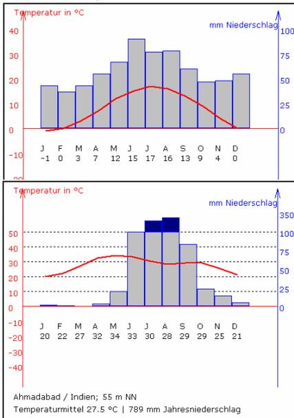
Zur grafischen Kennzeichnung von Klimawerten; Temperatur und Niederschlag; von Orten werden Klimadiagramme gezeichnet. Mit einer roten Linie werden der jährliche Temperaturverlauf, mit blauen Balken die Niederschlagsmenge gekennzeichnet.
