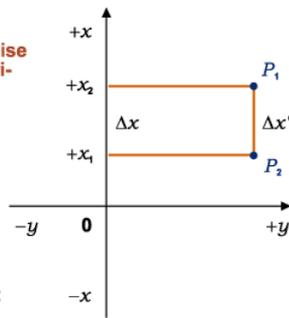
Die Ordinate  $y$  und die Abszisse  $x$  eines Punktes P sind durch die Strecken von den Fußpunkten der sphärischen Lote auf den durch den Zentralpunkt verlaufenden Hauptmeridian und auf den durch den Zentralpunkt verlaufenden Hauptbreitenkreis gegeben (rechte Abbildung).
