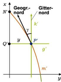
**Aufgabe:** Das Gradnetz einer Kugel ist auf einen Zylinder abzubilden, der die Kugel in einem Meridian berührt. Der Berührungsmeridian und der Äquator bilden die Achsen eines Gauß-Krüger-Systems.
