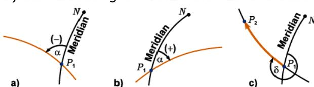
Der Kurswinkel ist ein orientierter, d.h. mit einem Vorzeichen versehener Winkel. Er ist unabhängig von der Orientierung der Kurve - das ist ihr Durchlaufsin. Die Orientierung der Kurve von  $P_1$  nach  $P_2$  gemäß Teil c) der
