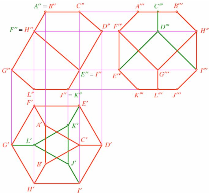
Das Polyeder hat als Seitenflächen zwei kongruente gleichseitige Dreiecke und sechs kongruente achsensymmetrische, aber nicht regelmäßige Fünfecke. Es hat Punktsymmetrie, eine dreistrahligere Drehsymmetrie (Achse durch die beiden Dreiecksmitten), drei Achsen mit zweistrahligere Drehsymmetrie (Achsen durch Mittelpunkte gegenüberliegender langer Fünfeckskanten) und drei Symmetrieebenen.
