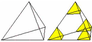
Ein abgestumpftes Tetraeder ist ein Körper, der von 4 regelmäßigen Sechsecken und 4 gleichseitigen Dreiecken gebildet wird. Es entsteht aus einem Tetraeder, indem man an den Ecken dreiseitige Pyramiden abschneidet. Das abgestumpfte Tetraeder sei durch die Kantenlänge  $a$  gegeben. Die Oberfläche setzt sich aus den Flächeninhalten der vier Sechsecke und der vier Dreiecke zusammen. Damit wird  $A = 4 A_6 + 4 A_3 = 7 \sqrt{3} a^2$
