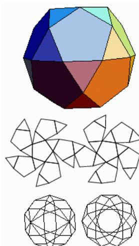
Das Ikosidodekaeder entsteht aus einem Ikosaeder, wenn man an den Ecken passend fünfseitige Pyramiden abschneidet. Dazu halbiert man alle Kanten des Ikosaeders.
