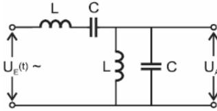
Diese Amplitude hängt von der Frequenz der Eingangsspannung ab. Das Amplitudenverhältnis  $H(\omega)$  ist
