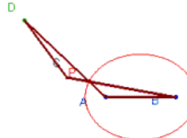
Ellipsograf zur Ellipsenkonstruktion mit Hilfe von Antiparallelogrammen
