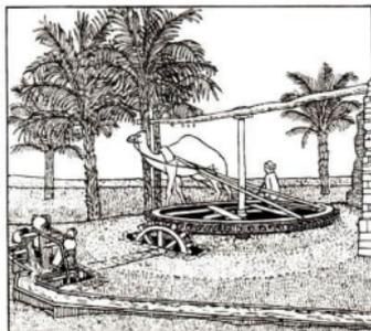
**Das Schöpfrad**, das über ein Göpelwerk mit tierischer Zugkraft angetrieben wird, ist am Nil und an den Flüssen Vorderasiens weit verbreitet.
