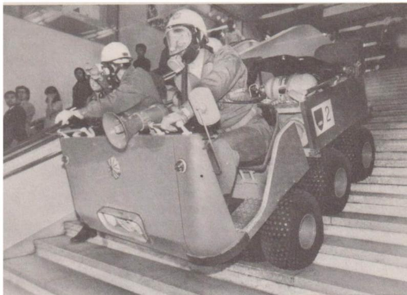
Elektrogetriebenes Rettungsfahrzeug auf 24 Rädern bei einer Übung im unterirdischen Geschäftszentrum von Osaka (Japan)
