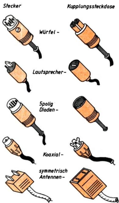
Bild 11.7 Die häufigsten Stecker und Kupplungssteckdosen bei Heimmtonbandgeräten
