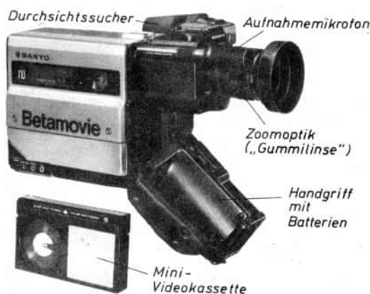
Bild 5.12 Kamerarecorder: Eine kleine Amateur-Fernsehkamera mit eingebautem Videorecorder.
