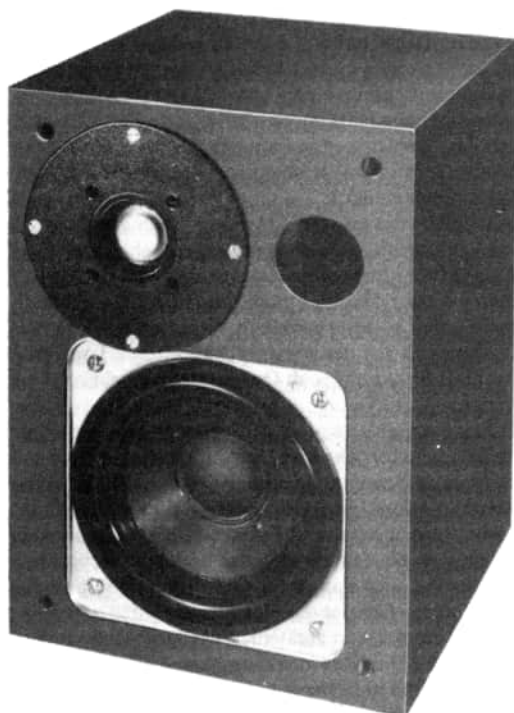
Bild 6.2 Moderne Zweigweg-Lautsprecherbox nach dem Baß-reflexprinzip (rechts mit abgenommener Frontverkleidung) Foto: Leue
