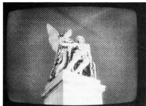
Bild 7.7 Eine mögliche Erscheinungsform von Moiré. Die Streifen können auch schmaler oder breiter sein, schlangenförmig oder fischgrätenartig verlaufen und ständig Form und Richtung ändern.
