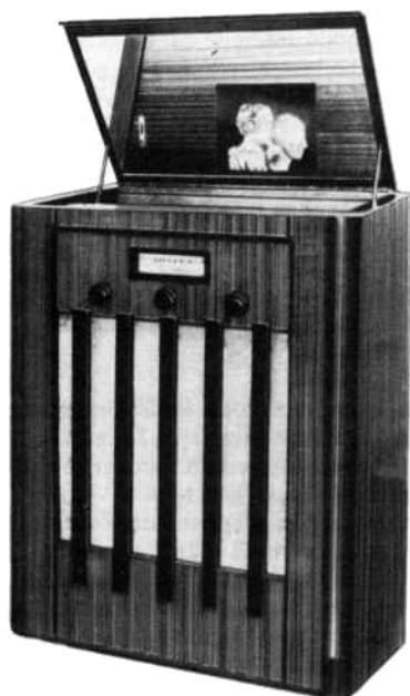
Bild 3.3 Einer der ersten industriell gefertigten Fernsehapparate mit senkrecht eingebauter Bildröhre, so daß das Bild über einen Umlenkspiegel betrachtet werden mußte.
