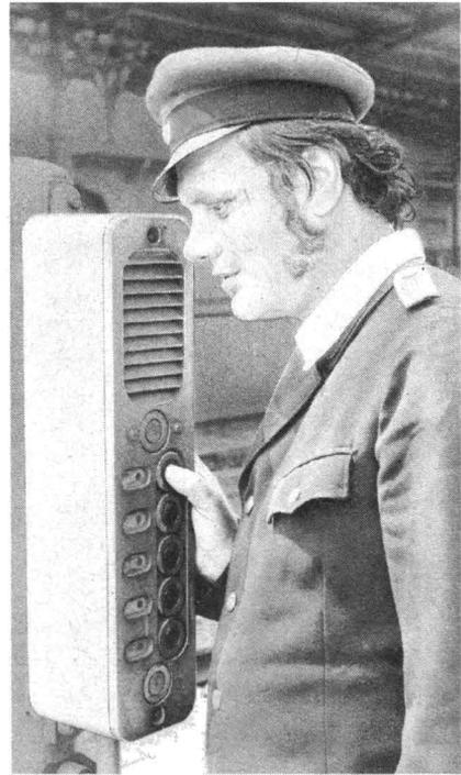
Bild 8.14. RWS-Anlage (Außensprechstelle)
