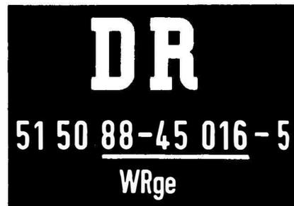
Bild 5.31. Anschrift an der Seitenwand eines Reisezugwagens von oben nach unten: Eigentumsmerkmal, Wagennummer, Gattungszeichen
