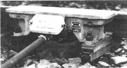
Bild 7.12. Magnete der punktförmigen Zugbeeinflussungsanlage PZ 80
