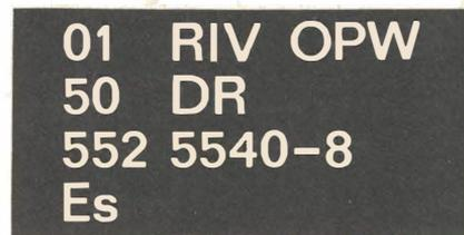
Bild 5.34. Anschrift an der Seitenwand eines Güterwagens (Ausschnitt)
