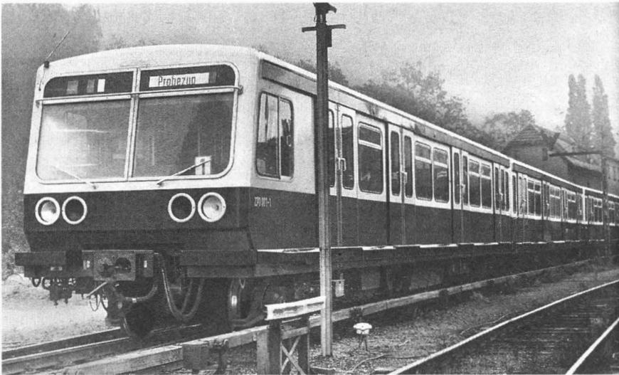
Bild 5.26. Elektrischer Triebwagenzug der Berliner S-Bahn BR 270, «Viertelzug»: Achsfolge Bo'Bo'+2'2', Länge über Kupplung = 36,2 m,  $m = 60$  t,  $P$  (je Triebwagen) = 600 kW (150 kW je Fahrmotor),  $v_{\max} = 90$  km/h
