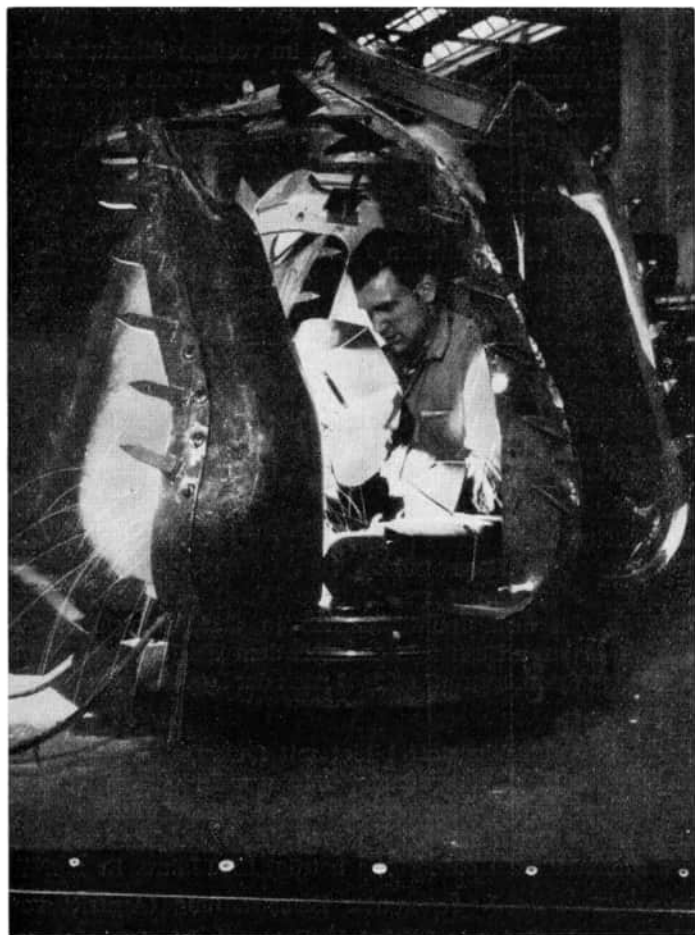
Bild 7. Kohlendioxid wird beim Schweißen als Schutzgas verwendet
