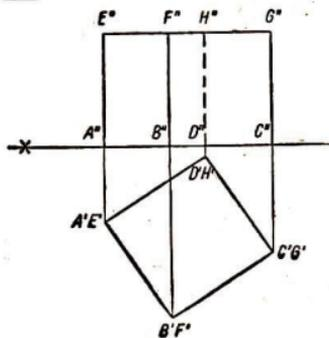
standes jeweils auf parallelen, zur Rißachse senkrechten Geraden liegen (Abb. 80c). Diese Geraden heißen **Ordnungslinien**; beim praktischen Zeichnen werden sie als Hilfslinien benutzt.
