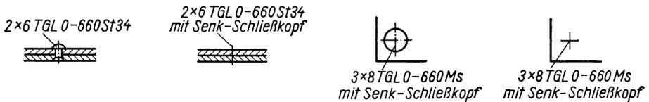
Bild 498. Vereinfachung für Kleindarstellung nach TGL 0-30
