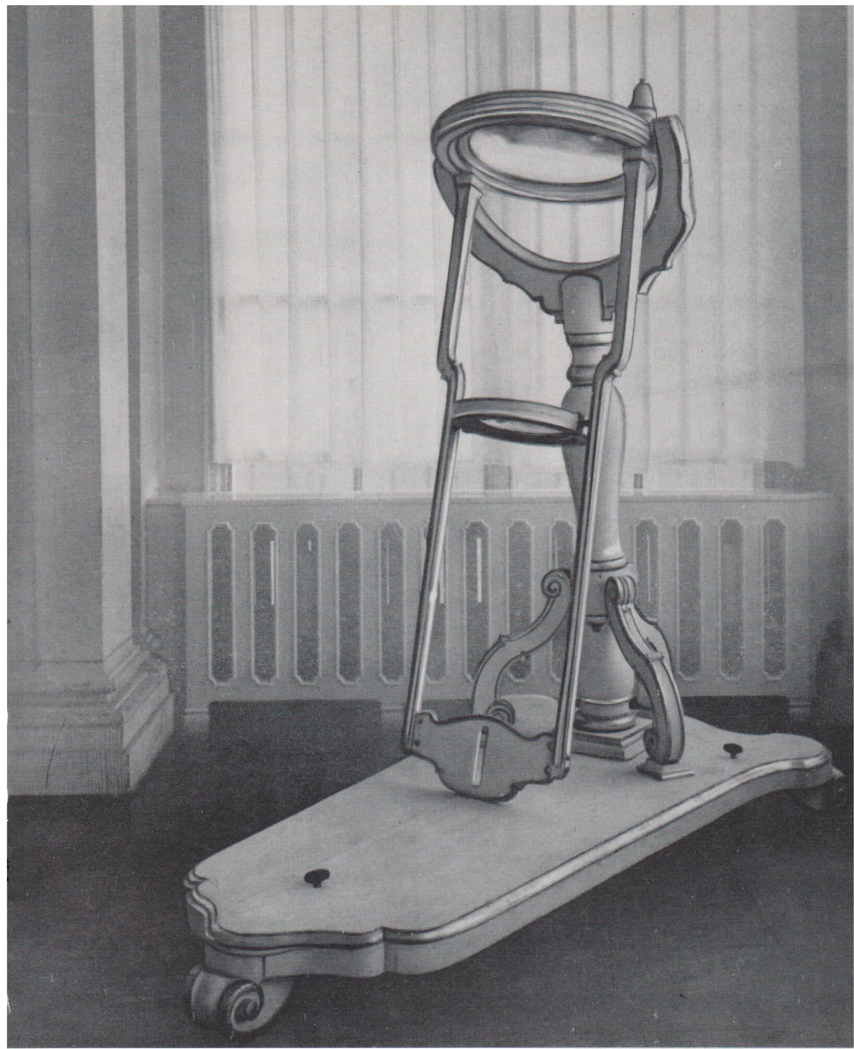
Doppelbrennlinse, um 1690 von Walter von Tschirnhaus für Friedrich Böttgers Schmelzversuche zur Porzellanherstellung gebaut (Staatlicher Mathematisch-Physikalischer Salon Dresden)
