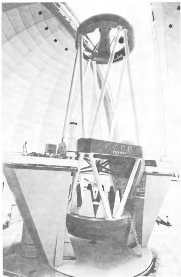
Abb. 66. Der 6-m-Spiegel des Astrophysikalischen Spezialobservatoriums
