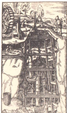
Pumpensystem zur Bergwerkentwässerung, nach AGRICOLAS Werk „De re metallica“
