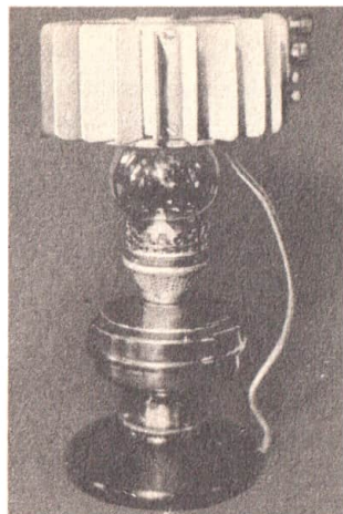
Thermoelektrischer Generator sowjetischer Bauart auf einer Petroleumlampe
