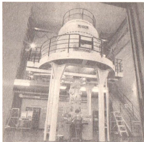
1000-KV-Höchstspannungs-Elektronenmikroskop am Institut für Festkörperphysik und Elektronenmikroskopie der AdW der DDR in Halle
