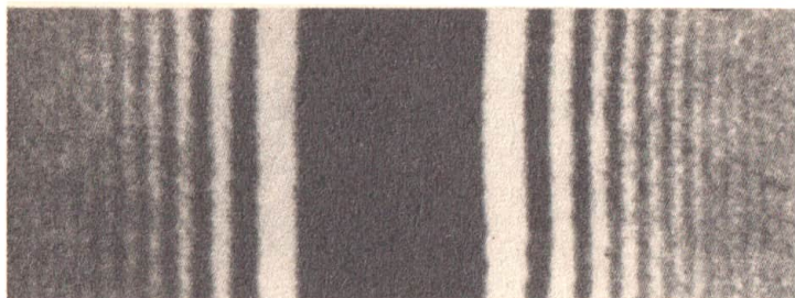
Beugungstreifen von Elektronen an einem 2 mm dicken vergoldeten Draht
