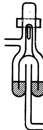
Bild 126. Quecksilberabsperrhahn für kleine Druckunterschiede
