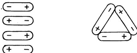
Bild D.12. Orientierung von Dipolmolekeln im festen und flüssigen Zustand
