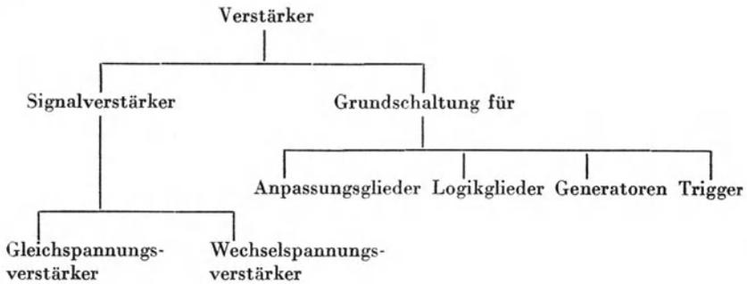
In diesem Teil sollen nur Wechselspannungsverstärker und Anpassungsglieder als deren Sonderformen beschrieben werden. Generatoren und Triggerschaltungen sowie Logikglieder bleiben den nachfolgenden Teilen vorbehalten.
