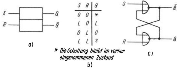
Bild 72. RS-Speicher-Flip-Flop
