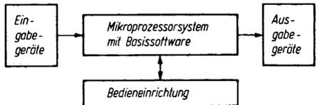
**Mikrorechnerarbeitsplatz.** M. bezeichnet einen Mikrorechner, der durch Anschluß von peripheren Geräten (Tastatur,  $\uparrow$ Bildschirmereinheit, Drucker,  $\uparrow$ Lochbandleser, Lochbandstanzer, Externspeicher) erweitert wurde.
