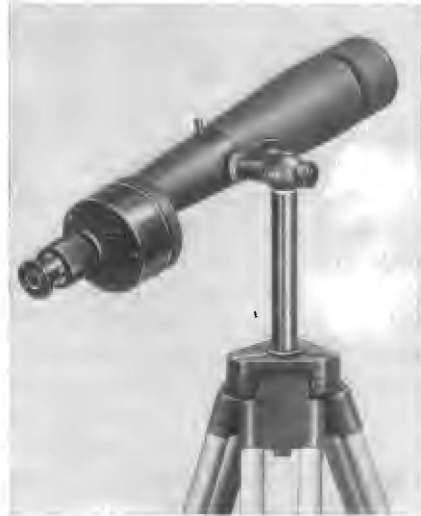
Abb. 16 „Asiolo“-Fernrohr des VEB Carl Zeiss, Jena. Öffnung 63 mm, fest angebauter Prismenumkehrsatz, Okularsteckhülse für Astrookulare 25 bis 10 mm (Vergrößerungen zwischen 17- und 42fach)
