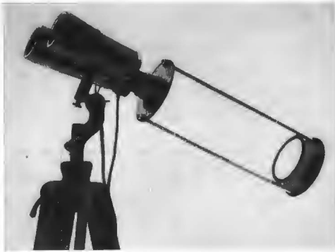
Abb. 21 Sonnenprojektionsschirm am ZEISS-Feldstecher 10\times 50 nach Vorschlag von Prof. ARTHUR KRAUSE, Leipzig
