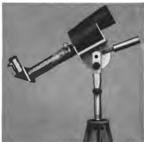
Abb. 26 Vorsatzfernrohr mit Zenitprisma am ZEISS-Feldstecher 15 \times 50 auf selbstgebaute Stativ. Ausführung und Photo R. KUHNHARDT, Eisleben
