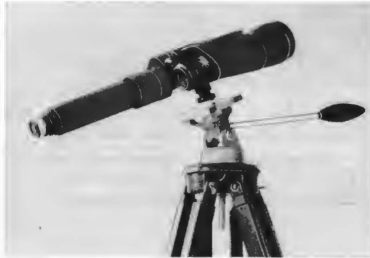
Abb. 28 Feldstecher 10 \times 50 mit Vorsatzfernrohr auf Photostativ mit Kinokopf (D. RICHTER, Erfurt)
